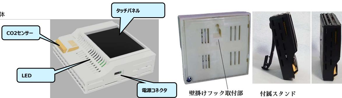
※タッチパネルは感圧式(樹脂製)のため、鋭利な物で押したり傷をつけたりしないようにして下さい。
